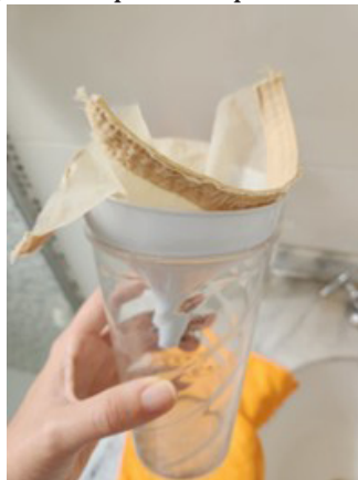
Figura 3. Pedaco de tecido, funil e copo usados para filtrar água e coletar zooplâncton
