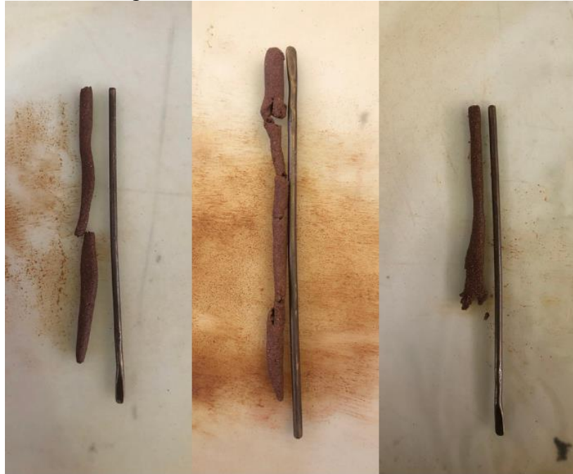
Figura 23 - Plasticidade da Amostra A2.
