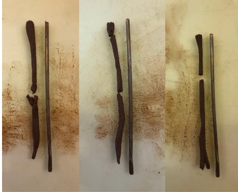
Figura 27 - Plasticidade da Amostra A3.
