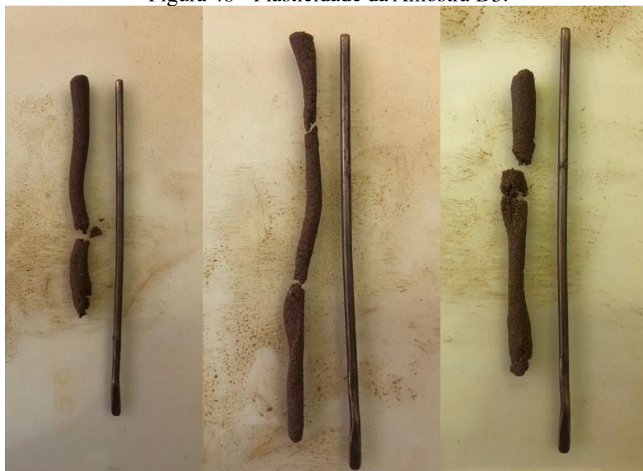
Figura 48 - Plasticidade da Amostra D3.
