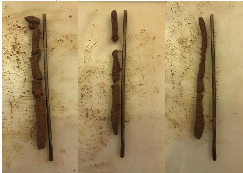
Figura 44 - Plasticidade da Amostra D2.
