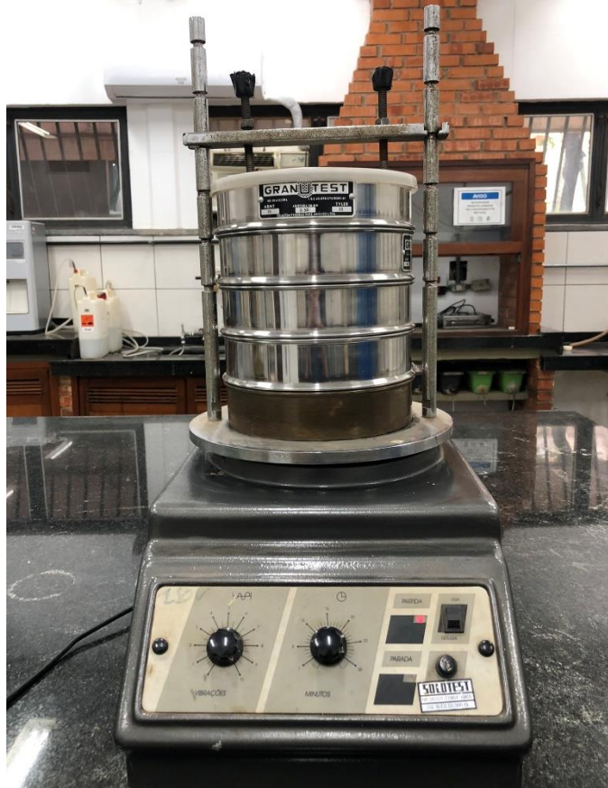
Figura 15 - Conjunto de peneiras e agitador mecânico.
