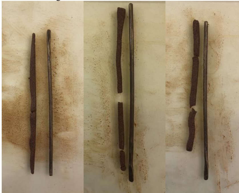
Figura 19 - Plasticidade da Amostra A1.
