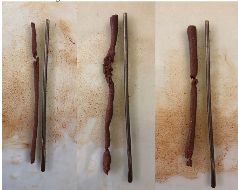
Figura 37 - Plasticidade da Amostra B3.
