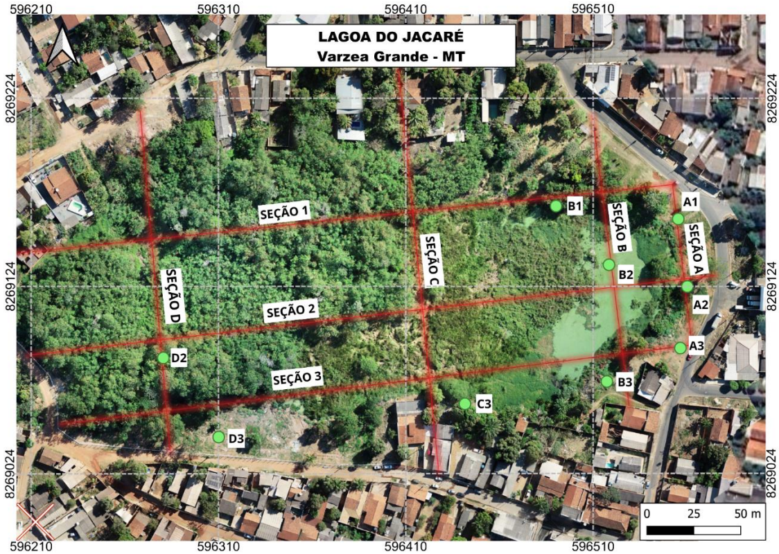
Figura 10 - Ortofoto com linhas de intercepto e pontos coletados na Lagoa do Jacaré.
